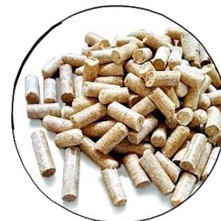
Гранулы, которые получаются в результате работы, подаются напрямую в колонну охлаждения. Древесные гранулы после гранулятора имеют высокую температуру до 70 С\* и не имеют твердой формы. Для того, чтобы охладить гранулы и придать им твердость и блеск, а также для того, чтобы отделить качественные гранулы от несгранулированных следует применить специальное оборудование – Колону охлаждения.
